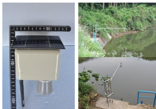
写真-1 小型水位計の外観と大久保ため池での設置状況
